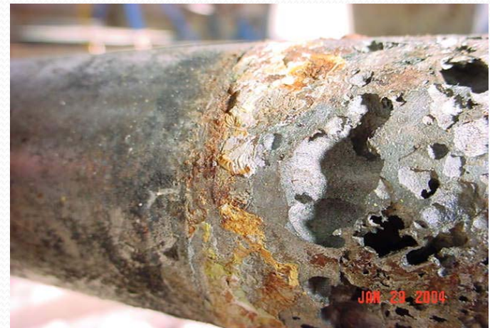
Bahaya korosi adalah salah satu kerugian penggunaan stainless steel (gambar shaft yang mengalami korosi)
